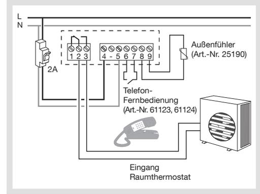
**Anschluss eines Heizlüfters oder einer Kühlanlage**
