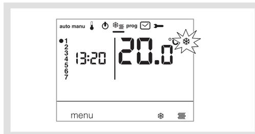
Im Modus **HL** muss darauf geachtet werden, die Wärmepumpe entsprechend dem am Thermostat gewählten Modus einzustellen.
