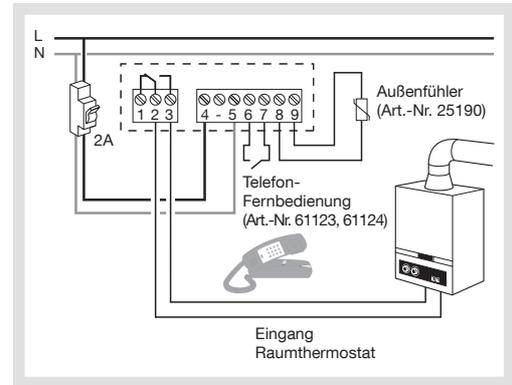
**Anschluss des Thermostats an den Thermostateingang einer (reversiblen oder nicht reversiblen) Wärmepumpe**
