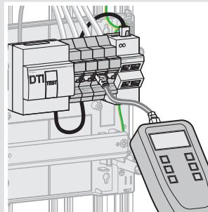
Vérification de la continuité des circuits RJ45 entre coffret et prises terminales à l'aide d'un testeur de continuité.
