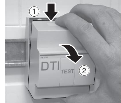
Pour ouvrir le DTI, appuyer sur le haut et le bas du capot et le retirer
