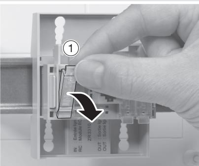
1. Basculer le couvercle du module de connexion.
