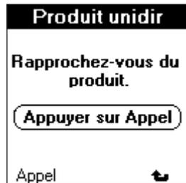
**Ecran 7 :** après l'appui sur **Appel**, un message indique qu'il faut appuyer sur le BP jusqu'à la détection tout en se rapprochant.
