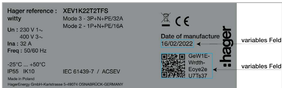
Abb. 1: Typenschild der Ladestation witty solar
