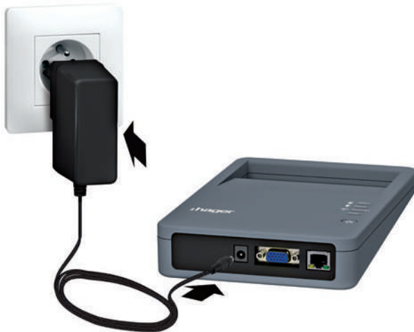
Unità di configurazione collegata alla rete elettrica
