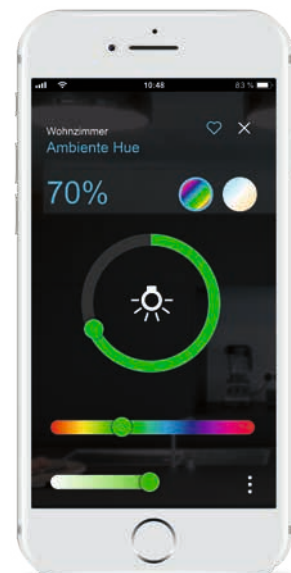
Langklick zur Detailsteuerung Hier: Dimmwert, W-Farbwahl und Farbtemperatur-Einstellung für DALI oder Philips-Hue-Lampen.
