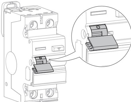
TEST / Jordfeilindikasjon: testes jevnlig. Bryteren skal slå ut.
