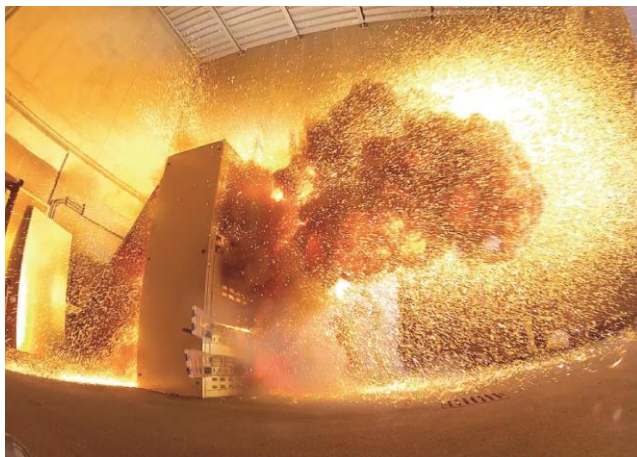
Arc électrique parasite provoqué en l'absence d'un système de protection contre les arcs électriques parasites
