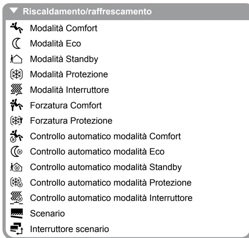
Figura 68: Panoramica del funzionamento del **Riscaldamento/raffrescamento**
