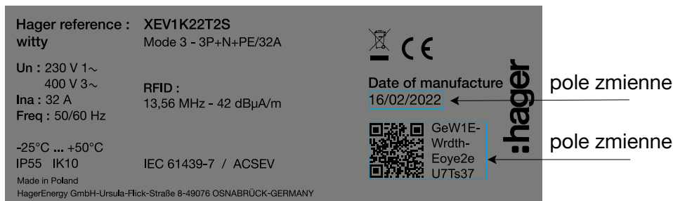
Rys. 1: Tabliczka znamionowa stacji ładowania witty solar
