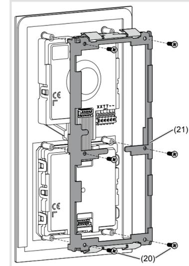
Image 19 : Démontage du support du module
