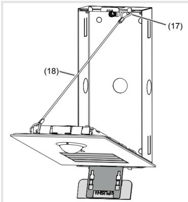
Image 6 : Position d'installation de la platine de rue
