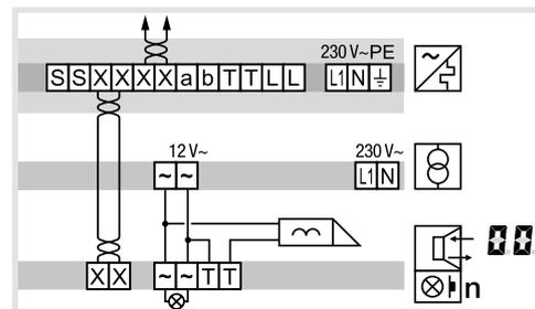
Figura 7: collegamento apriporta della stazione da porta
