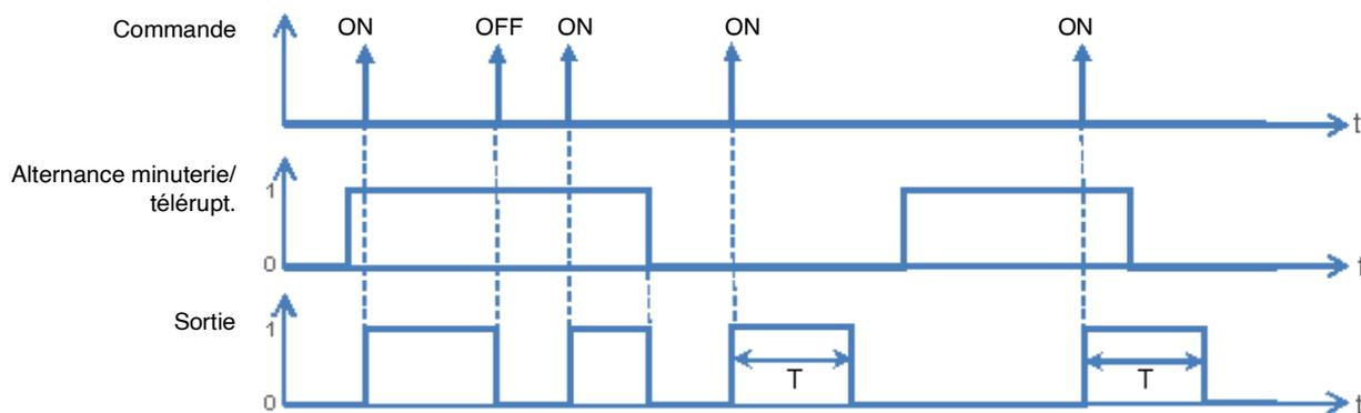
Objets de communication : [2, 22, ... 382 - Sortie x - Alternance minuterie/télerupt.](#) (1 bit - 1.001 DPT\_Switch)
