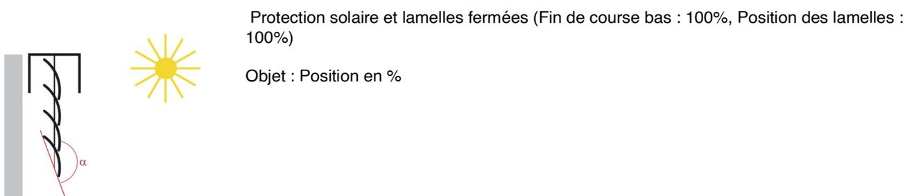
A partir de leur position verticale (totalement fermées, 100%), les lamelles peuvent être orientées jusqu'à la position horizontale (totalement ouvertes, 0% ou  $= 90^\circ$ ) Ici, le moteur de persienne utilisé détermine si cette modification de la position peut s'effectuer de façon fluide par enchaînement de nombreux mini pas d'inclinaisons successives ou si cette modification n'est possible que par la succession de quelques pas d'inclinaisons (Comme avec les moteurs standards).
