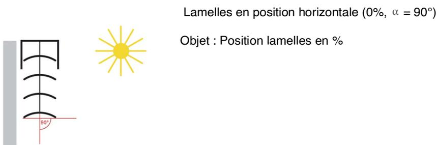
Avec des persiennes standard, la position des lamelles depuis l'horizontale peut être modifiée plus avant, jusqu'à ce que l'inclinaison de la position des lamelles arrive à son terme et que la montée des jalousies débute. À ce moment, les lamelles forment avec la verticale un angle compris entre  $0^\circ$  et  $90^\circ$ .
