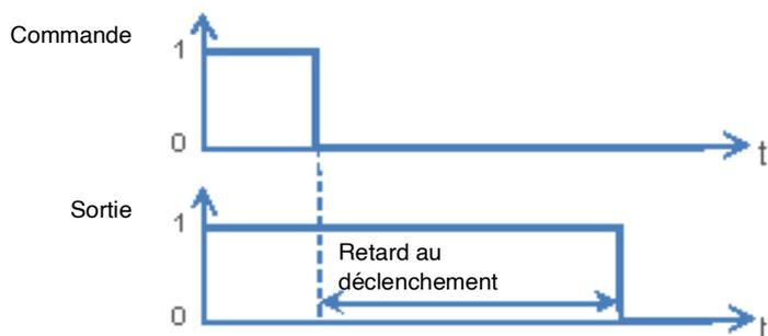
**Retard à l'enclenchement et au déclenchement** : Permet de paramétrer un délai entre la commande d'allumage et la commutation du contact de sortie et entre la commande d'extinction et la commutation du contact de sortie.
