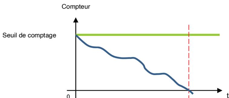
Le compteur démarre à partir du seuil de comptage des heures (objet **Seuil de comptage heures**) et est décrémenté. Lorsque le compteur est à 0, l'objet **Seuil de comptage heures atteint** est mis à 1 et est émis sur le bus.
