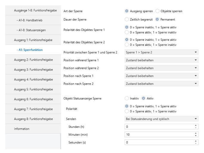
Mit der Sperrfunktion kann ein Ausgang in einem vordefinierten Zustand gesperrt werden.
