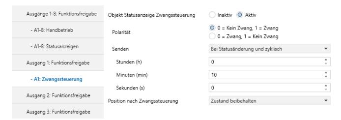
Mit der Zwangssteuerfunktion kann für einen Ausgang ein vordefinierter Zustand erzwungen werden.
