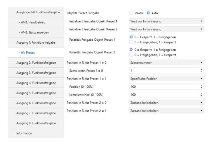
Mit der Preset-Funktion kann ein Ausgang in verschiedene vordefinierte Zustände versetzt werden. Die Preset-Funktion wird über Objekte im 1-Bit-Format aktiviert.
