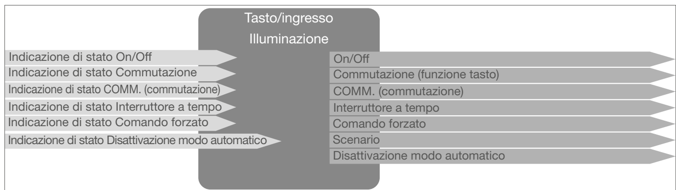
Figura 3: Segnali di ingresso/uscita della funzione Illuminazione
