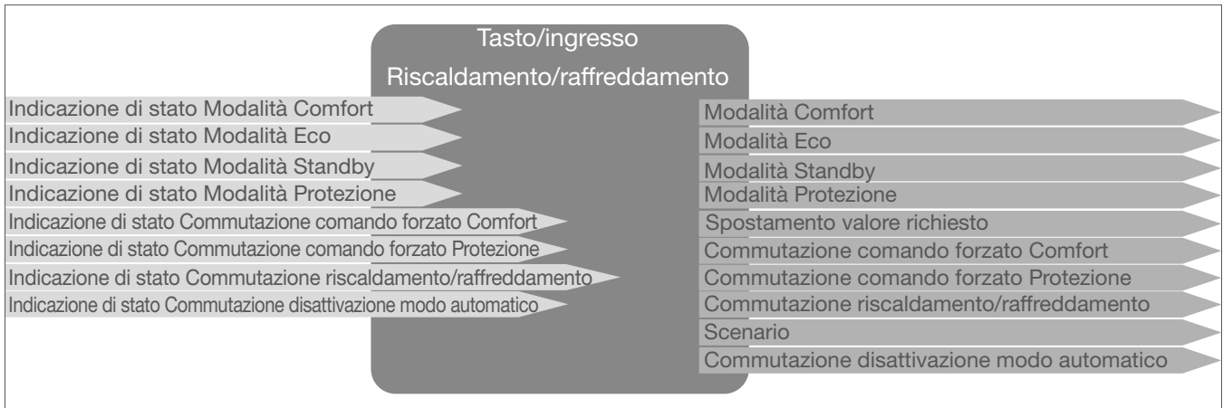
Figura 6: Segnali di ingresso/uscita della funzione Riscaldamento/raffreddamento
