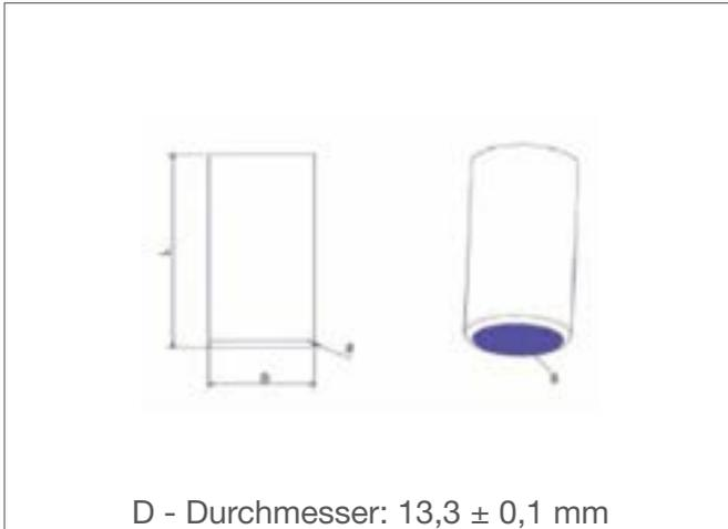
Abb 5: Prüfstempel
