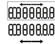
Compteur d'énergie (kWh), remise à zéro impossible
