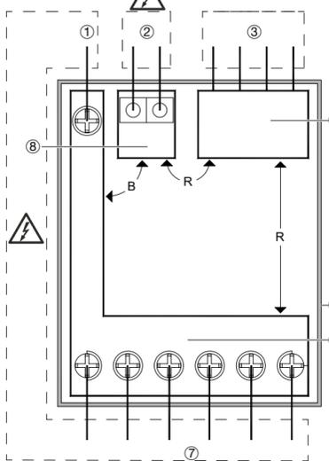
Non sono presenti parti accessibili. Legenda: B = Isolamento di base D = Isolamento doppio R = Isolamento rinforzato F = Isolamento funzionale
