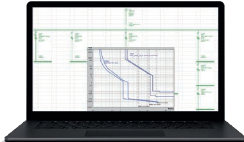
Logiciel de calcul de réseau électrique Permet de calculer la sélectivité entre les différents organes de protection selon les valeurs de court-circuit présumées.
