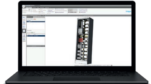
Logiciel Hagercad Logiciel de conception et de chiffrage de tableaux de distribution tertiaire jusqu'à 4000A.
