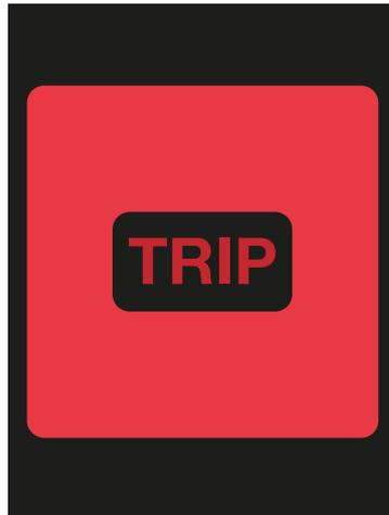
Kurz auf die Taste OK der Auslöseeinheit drücken, um die Anzeige des Fensters zu fixieren und die Auslöseart und Zusatzinformationen zur Ursache anzuzeigen.
