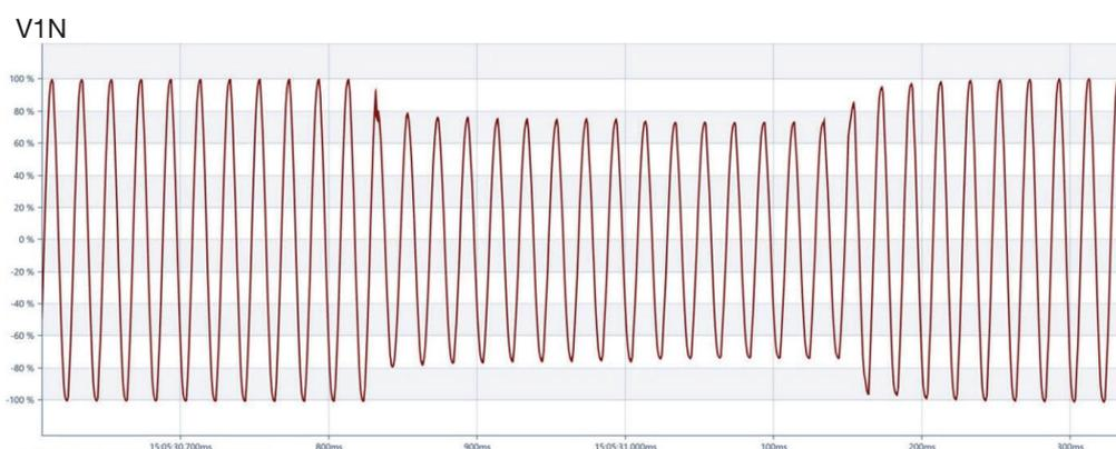
I picchi di tensione sono meno comuni dei cali di tensione. Possono essere causati da un guasto a terra su una sola linea, che aumenta conseguentemente il livello di tensione delle altre fasi. È possibile che si manifestino anche durante l'arresto di un carico importante.
