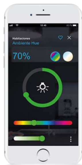
Pulsar y mantener para un control detallado Opciones mostradas: Valor de regulación de luz, ajustes de elección del color y de temperatura del color para luces DALI y Philips Hue.
