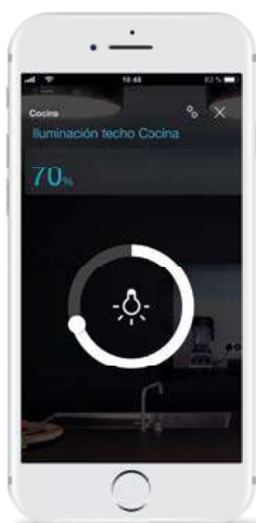
Gestión de una luz para: ON/OFF y regulación (KNX, DALI o Hue)
