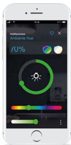
Gestión de una luz para: ON/OFF, regulación y ajuste del color y de la temperatura del color (KNX, DALI o Hue)
