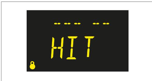
Le relais a détecté plus de transformateurs toroïdaux qui ne sont pas enregistrés dans l'installation.
