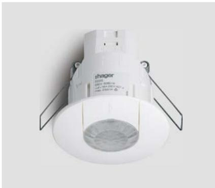
Los detectores de presencia reaccionan al movimiento y la presencia de personas. Pueden apagar la luz si la iluminación natural alcanza el nivel parametrizado, lo que permite ahorrar en los costes de energía.
