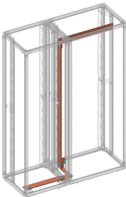
Haupt-PE-Traversierung von vorne unten nach hinten oben mit der Möglichkeit eines Abgangs PE unten
