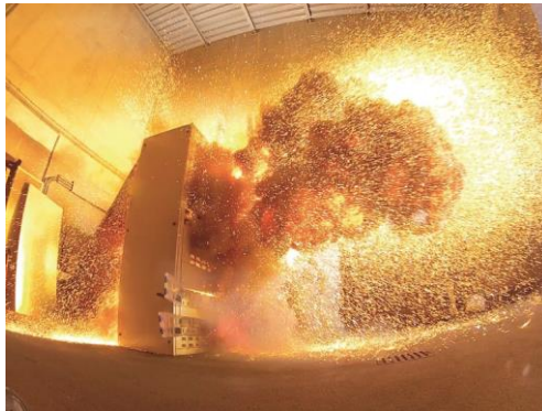
Provozierter Störlichtbogen bei fehlendem Störlichtbogen-Schutzsystem. Auftretende Störlichtbogen können tödliche Unfälle verursachen.
