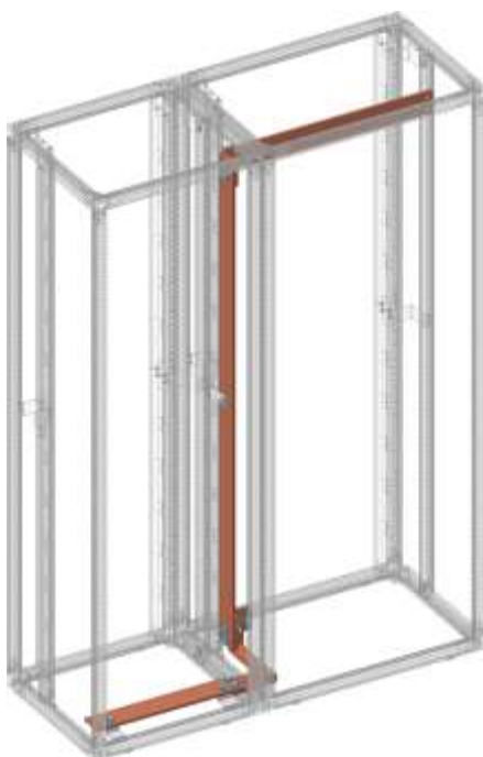
Traversée du PE principal de l'avant en bas vers l'arrière en haut, avec la possibilité d'un PE de départ en bas
