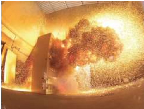
Arc électrique parasite provoqué en l'absence d'un système de protection contre les arcs électriques parasites. L'apparition d'arcs électriques parasites peut occasionner des accidents mortels.
