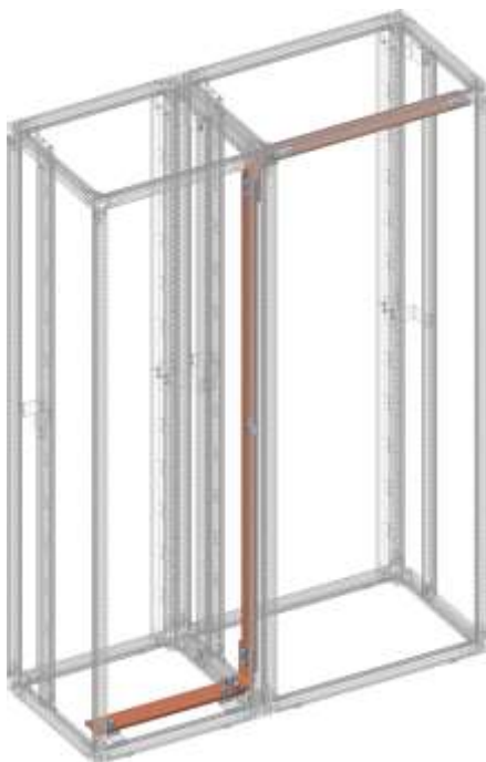
Traversée du PE principal de l'avant en bas vers l'avant en haut
