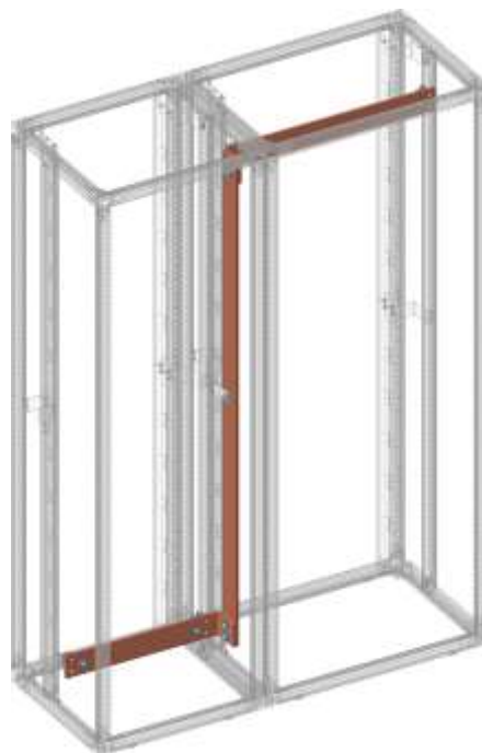
Traversée du PE principal de l'arrière en bas vers l'arrière en haut
