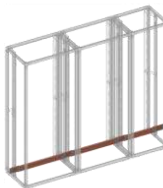
PE principal en bas, à l'arrière, vertical
