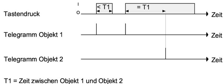
Bild 11: Beispiel zum Bedienkonzept "Objekt 1 und Objekt 2"
