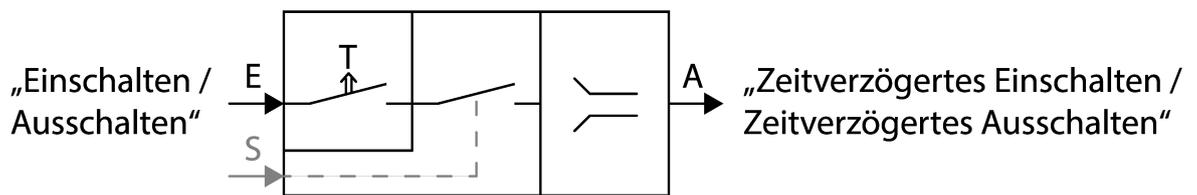
Bild 19: Schematische Darstellung "Zeitverzögert Ein- und Ausschalten"
