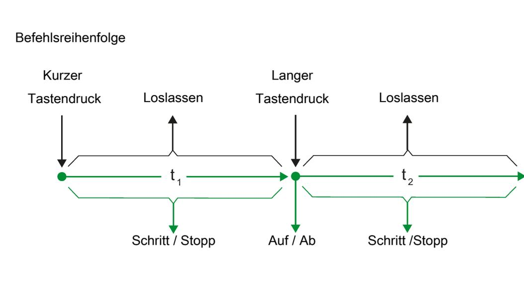
Bild 9: Bedienkonzept "Auf/Ab – Schritt oder Schritt"
