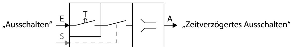
Bild 18: Schematische Darstellung "Zeitverzögert Ausschalten"
