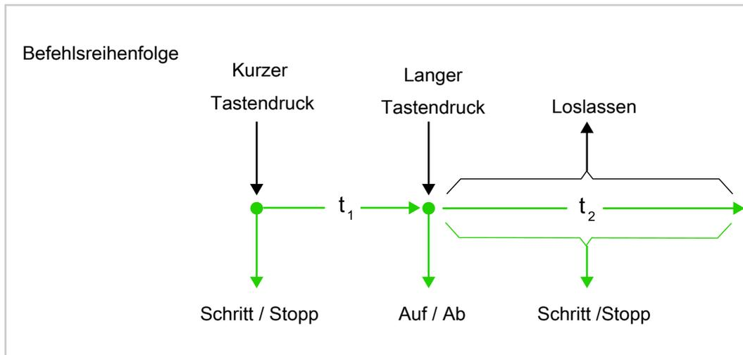
Bild 6: Bedienkonzept "Schritt-Auf/Ab-Schritt"
