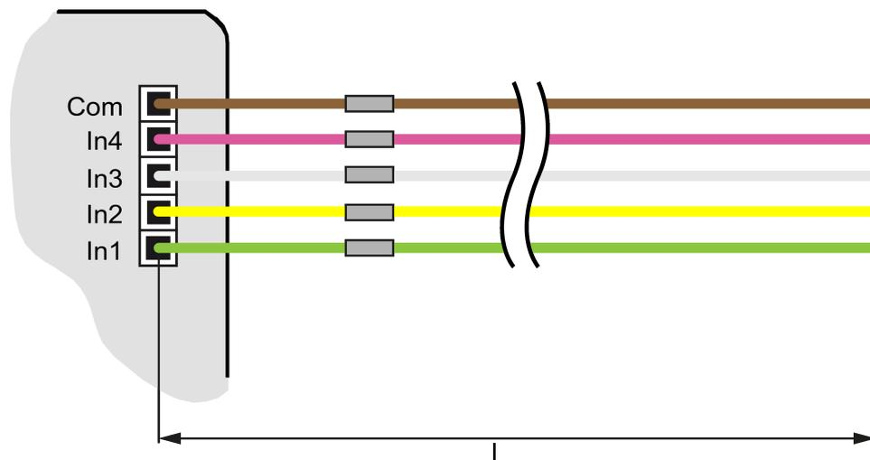
Bild 3: Maximale Leitungslänge
