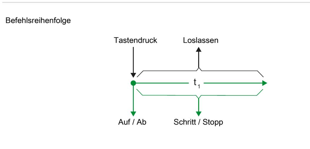
Bild 7: Bedienkonzept "Auf/Ab – Schritt"
