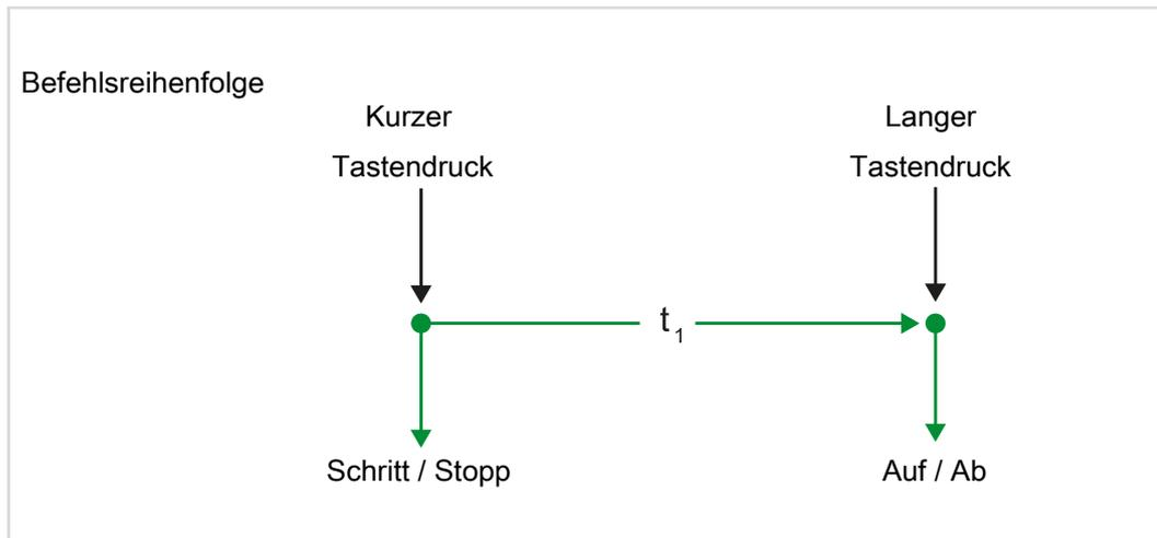
Bild 8: Bedienkonzept "Schritt - Auf/Ab"
