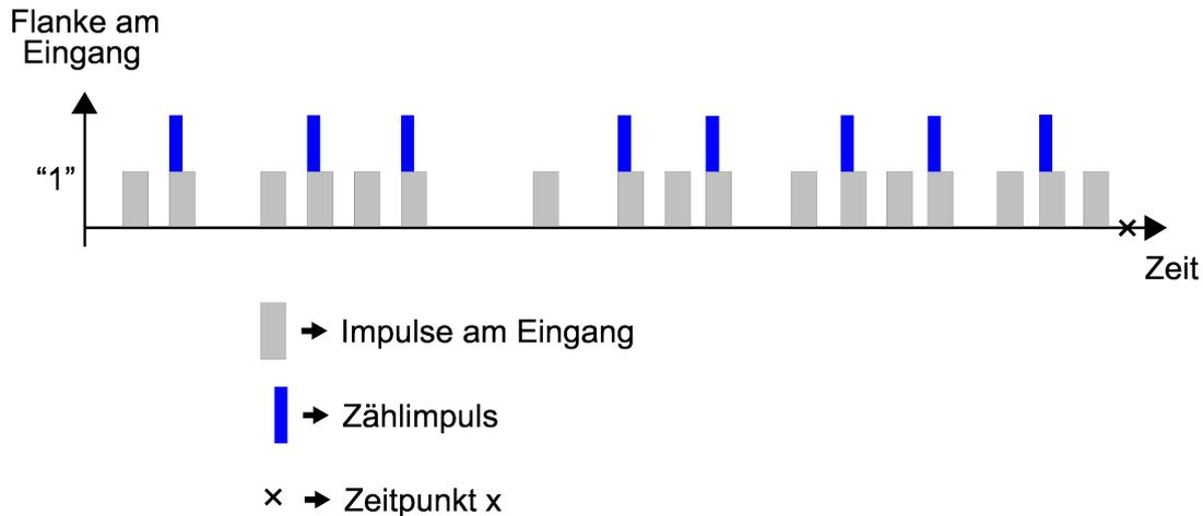
Bild 14: Beispiel zur Einstellung der Zählerstandsänderung pro Zählimpuls
