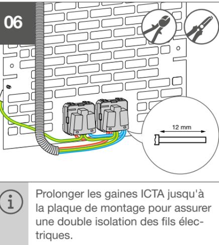
**i** Prolonger les gaines ICTA jusqu'à la plaque de montage pour assurer une double isolation des fils électriques.
