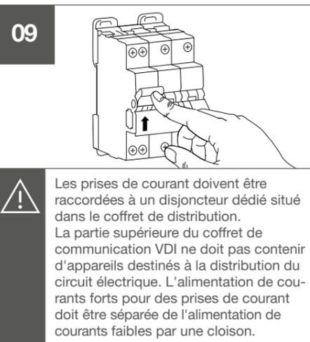
**!** Les prises de courant doivent être raccordées à un disjoncteur dédié situé dans le coffret de distribution. La partie supérieure du coffret de communication VDI ne doit pas contenir d'appareils destinés à la distribution du circuit électrique. L'alimentation de courants forts pour des prises de courant doit être séparée de l'alimentation de courants faibles par un cloison.
