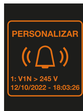
Ejemplo de sobretensión individual V1N.
