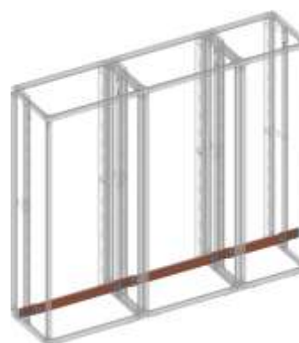
Główny PE na dole, z przodu, stojąco
