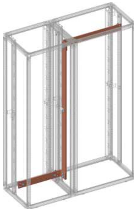
Przejście głównego PE z tyłu na dole > z tyłu na górze
