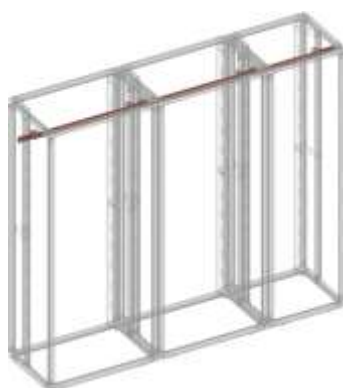
Główny PE na górze, z przodu, stojąco
