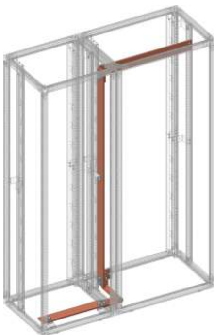
Przejście głównego PE z przodu na dole > z tyłu na górze z możliwością wykonania szyny wyjściowej PE na dole.
