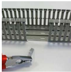
Ruptura de la lengüeta hasta la base con ayuda de herramienta
