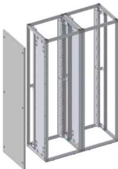
Montage der Schranktrennwand mit 8 Schrauben
