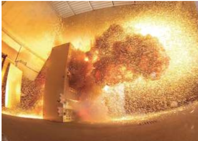
Provozierter Störlichtbogen bei fehlendem Störlichtbogen-schutz
