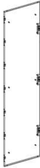
Volltür mit 7 Scharnieren und 3 Verschlüssen
