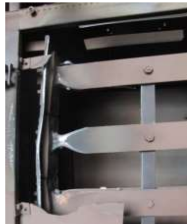
Lourds dommages sur l'installation avec coûts induits importants à la suite d'un arc électrique parasite
