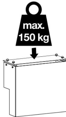
Je nach Wandoberfläche und -art (Gipskartonplatten, Ziegel, Beton etc.) muss geeignetes Befestigungsmaterial verwendet werden. Es wird empfohlen, max. Schrauben Ø 12 mm und entsprechende Unterlegscheiben in Kombination mit passenden Dübeln für den jeweiligen Wandtyp zu verwenden.
