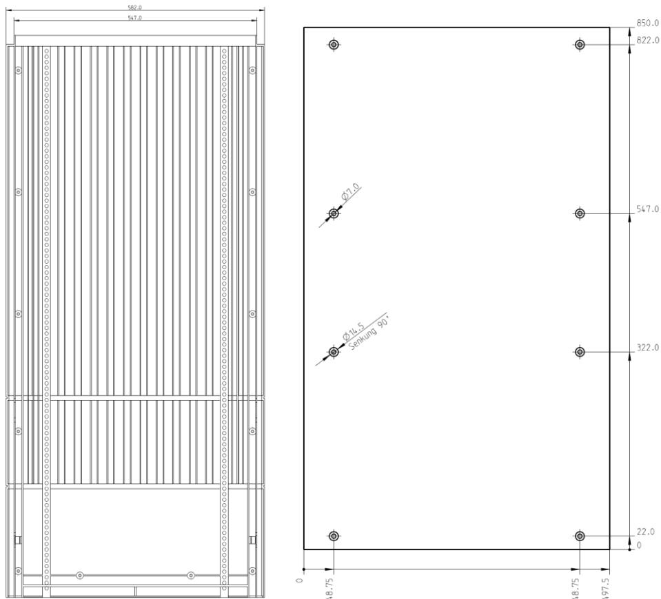
*Links:* Repräsentative Abbildung einer Rückwand eines leeren Schranks mit der Lochleiste zur Befestigung der Montageplatte. *Rechts:* Repräsentative Abbildung einer Montageplatte.
