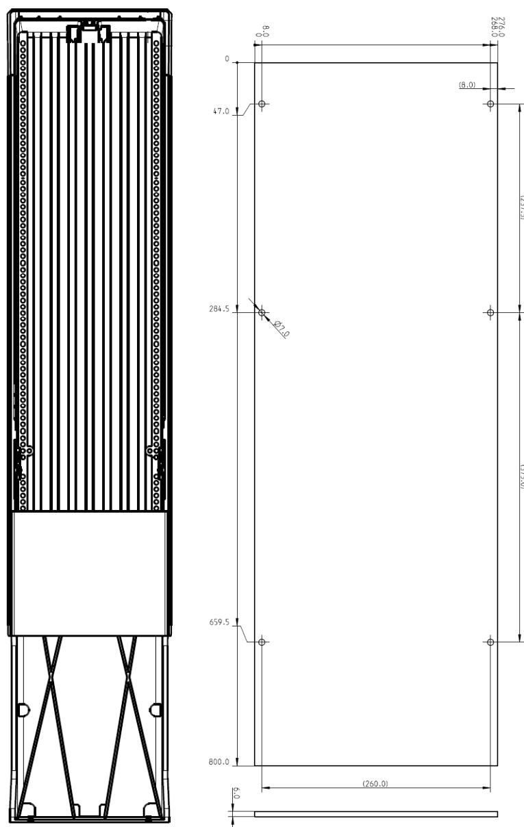
*Links:* Repräsentative Abbildung einer Rückwand eines leeren Schranks mit der Lochleiste zur Befestigung der Montageplatte. *Rechts:* Repräsentative Abbildung einer Montageplatte.
