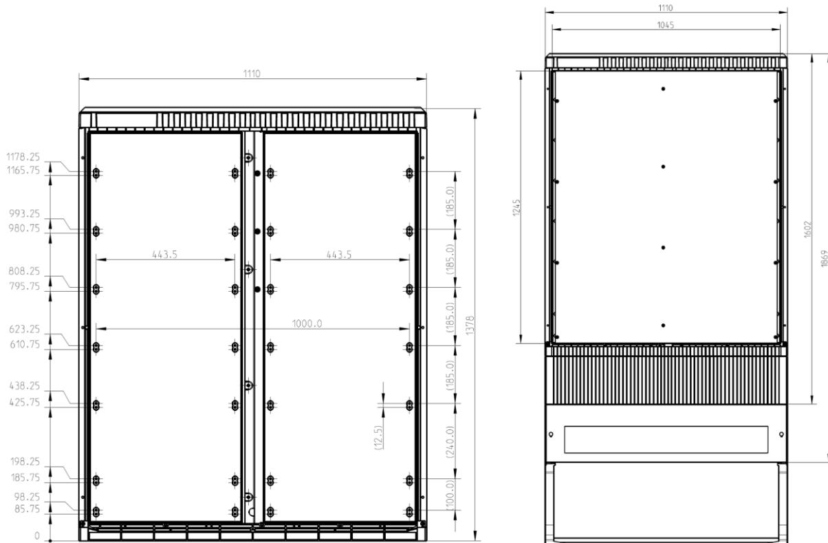
*Links:* Repräsentative Abbildung eines leeren Schranks mit der Positionierung der Dome für die Befestigung der Montageplatte. *Rechts:* Repräsentative Abbildung eines Gehäuses mit der Montageplatte im Inneren.
