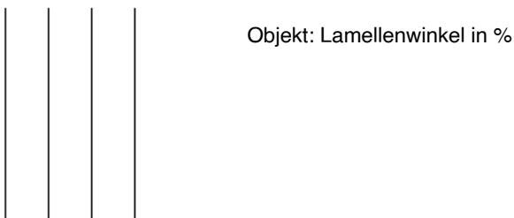
Sind die Lamellen vollständig geschlossen, so wird diese Stellung als Lamellen-Stellung 100% angesteuert bzw. gemeldet. Dies ist diejenige Stellung, in der der Blendschutz aus seiner seitlichen Endlage vor das Fenster gefahren wird. Der Winkel, den die Lamellen mit der Fahrtrichtung bilden, ist hierbei etwas > 0°.
