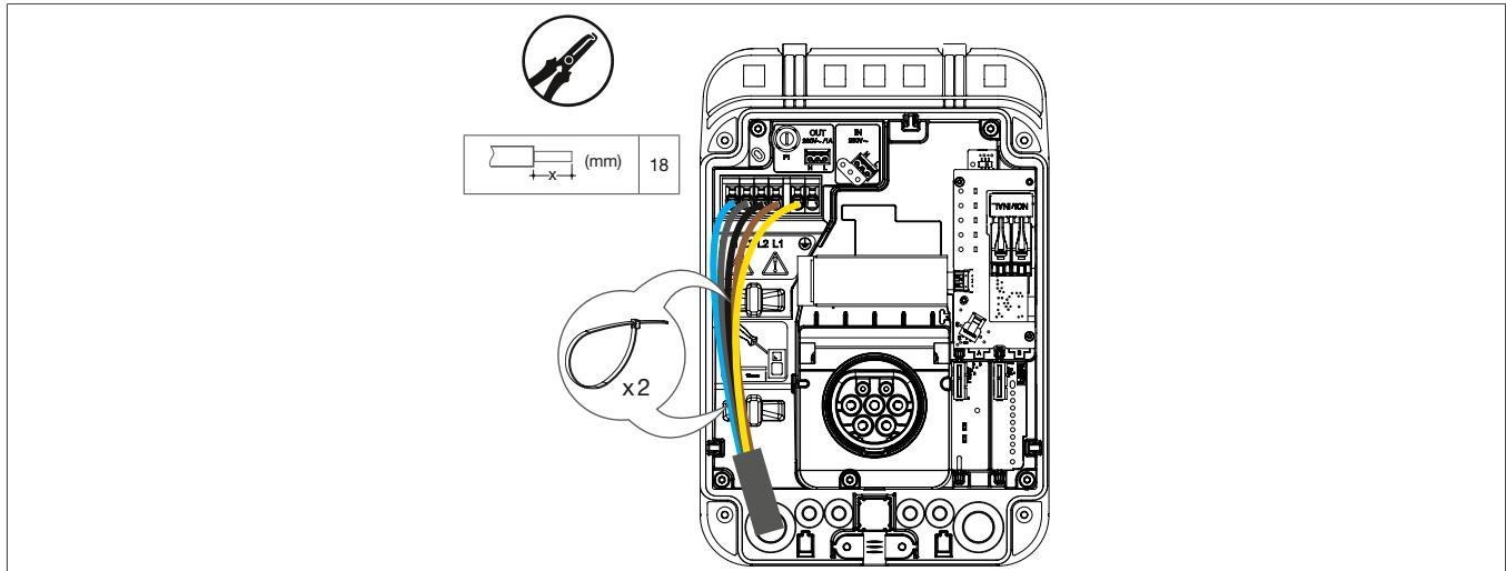
Le bornier d'alimentation est un bornier à ressort.
