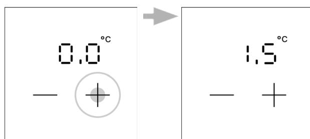
Tippen auf +: Raumtemperatur erhöhen (Basissollwertverschiebung Richtung PLUS)
