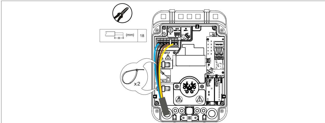
Der Anschlussklemmenblock der Stromversorgung ist ein federbelasteter Anschlussklemmenblock.
