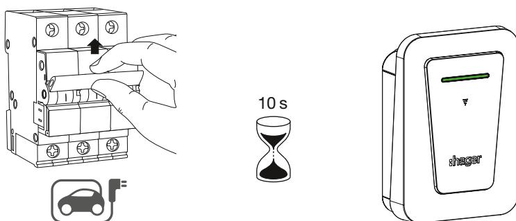
Die Ladestation ist nun betriebsbereit. Sie kann zum Laden eines Elektrofahrzeugs eingesetzt werden.
