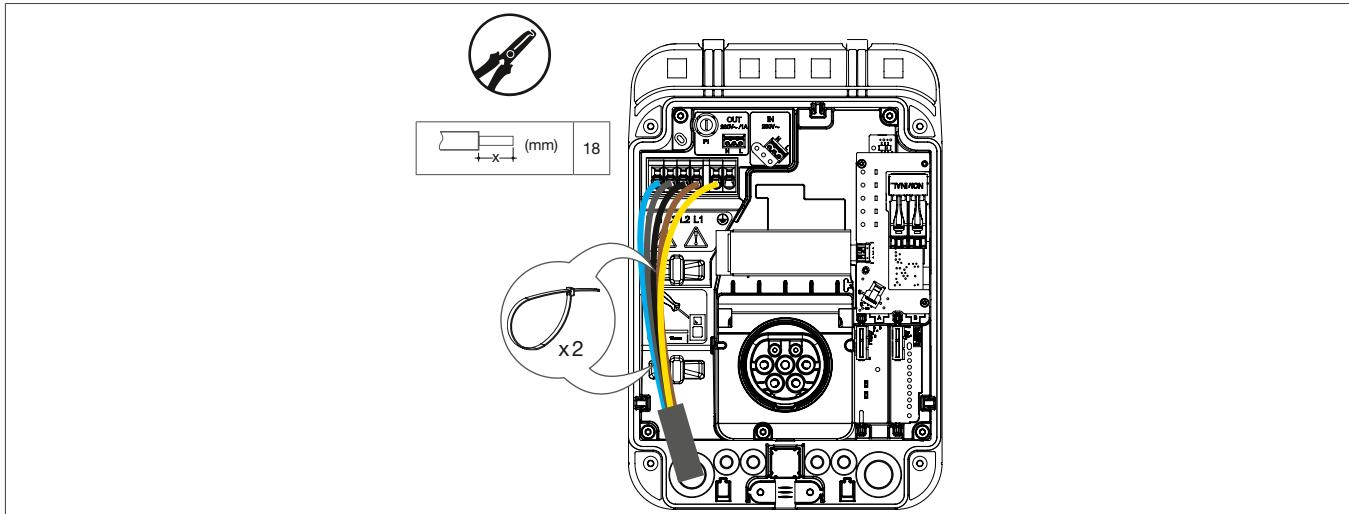
O bloco de terminais da fonte de alimentação corresponde a um bloco de ligação rápida.
