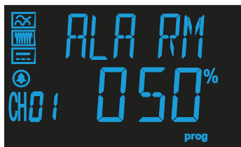
Bild 35: Auslösestrom des Voralarms
