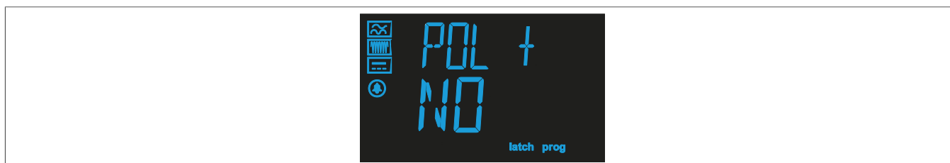
Bild 37: Betrieb des Voralarms
