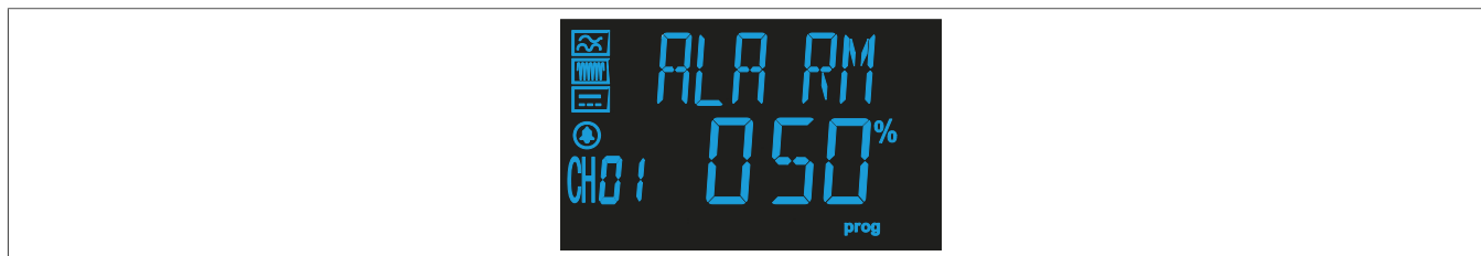
Fig. 35 : Courant de déclenchement de la pré-alarme
