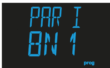
Fig. 30: Bit di dati, bit di stop e parità
