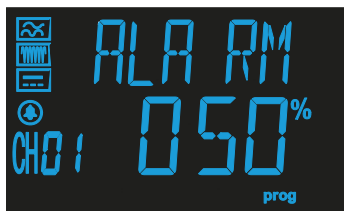
Fig. 35: Corrente di preallarme
