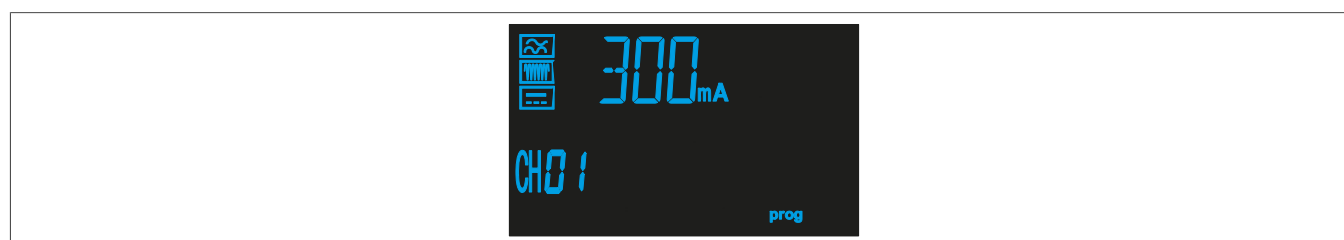
Fig. 23: Schermata della corrente di intervento
