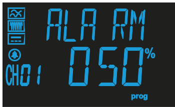
Bild 35: Auslösestrom des Voralarms
