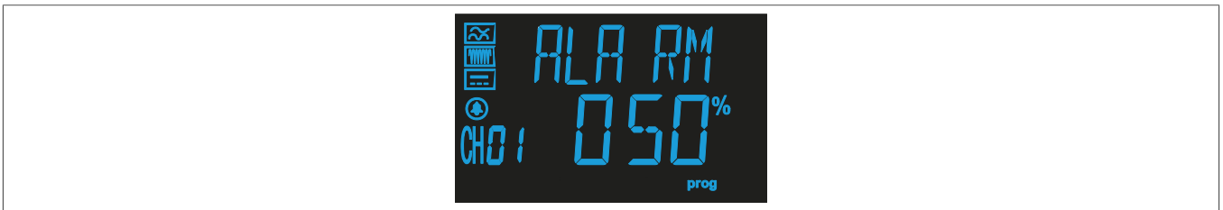
Fig. 35 : Courant de déclenchement de la pré-alarme
