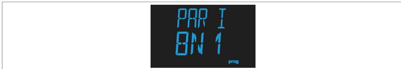
Fig. 30 : Bits de données, bits d'arrêt et parité
