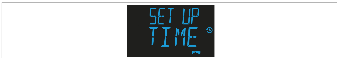
Fig. 31 : Menu de configuration Réglage du temps
