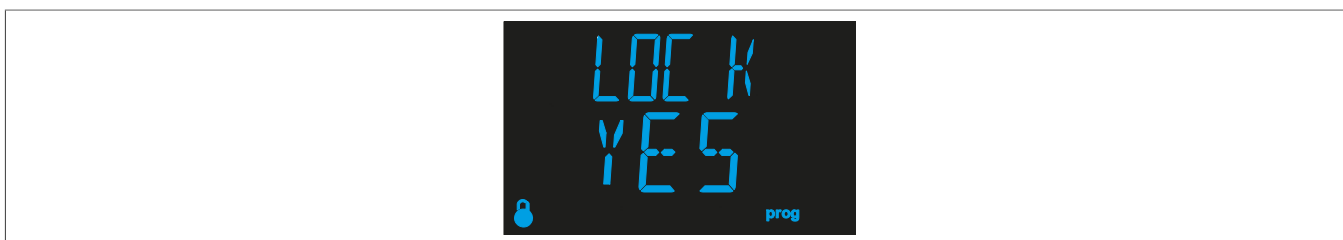
Fig. 19 : Le verrouillage de l'appareil est activé
