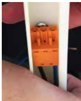
Integrierter Kabelkanal im mittleren Bereich unterhalb der Tragschiene
