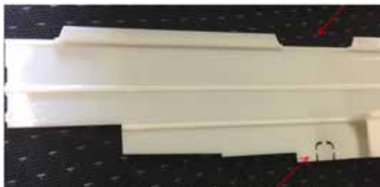
Ø12mm Vorprägungen oben/unten für einen sauberen Kabeldurchgang
