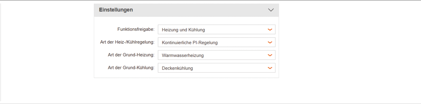
Bild 10: Raumtemperaturregelung - Thermostat (FCU)
