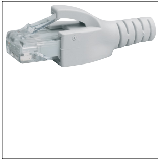
Abschlusswiderstand RJ45 für MODBUS RTU 120 Ohm
