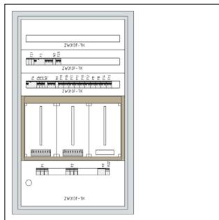
**UP-Zählerverteiler Ktn, 3ZPL, bestückt u. verdrahtet, 1243x711x253mm Nischenmaß**
