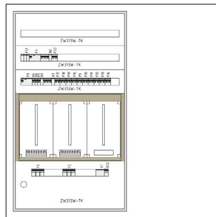
**AP-Zählerverteiler Ktn, 3ZPL, bestückt und verdrahtet, 1326x747x250mm Außenmaß**
